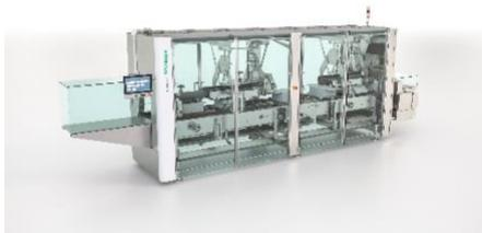
Mit einer Leistung von bis zu 200 Kartons pro Minute bietet der Kliklok ACC Unternehmen die Geschwindigkeit und Flexibilität, die für effiziente und zuverlässige Verpackungsprozesse erforderlich sind.
